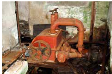
Peltonova turbina v Rakovški žagi
